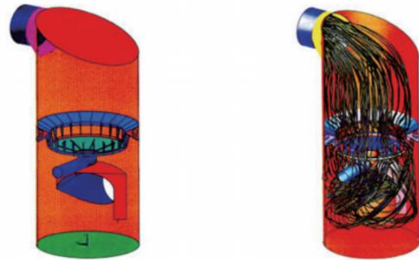
吸收塔三维流体试验
