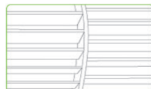
42片x2层，错位分布，使音波相对，缓冲抵消，从而实现降噪。
