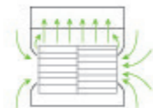
蜗壳进风口拱弧形设计，减小进风气流扰动，进风更顺畅，降低噪音。
