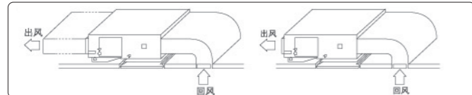
30Pa静压（标准出场状态），满足较远的送风距离要求并输出充足的冷量或热量 0Pa静压直吹（现场拆解），保证输出充足的冷量或者热量的同时获得更低的噪音
